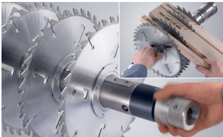
Niti jedna pila do sada nije bila podešena tako brzo, jednostavno i udobno kao s patentiranim Quickfix sustavom. Sve je sređeno u najkraćem roku: jednostavno rukom otpustiti hidraulično upinjanje listova pile, umetnuti uzorke drva željene širine, pomaknuti listove pile po osi pile te opet hidraulično upeti. Gotovo. Bez natične puše, bez distantskih prstena, bez alata.
