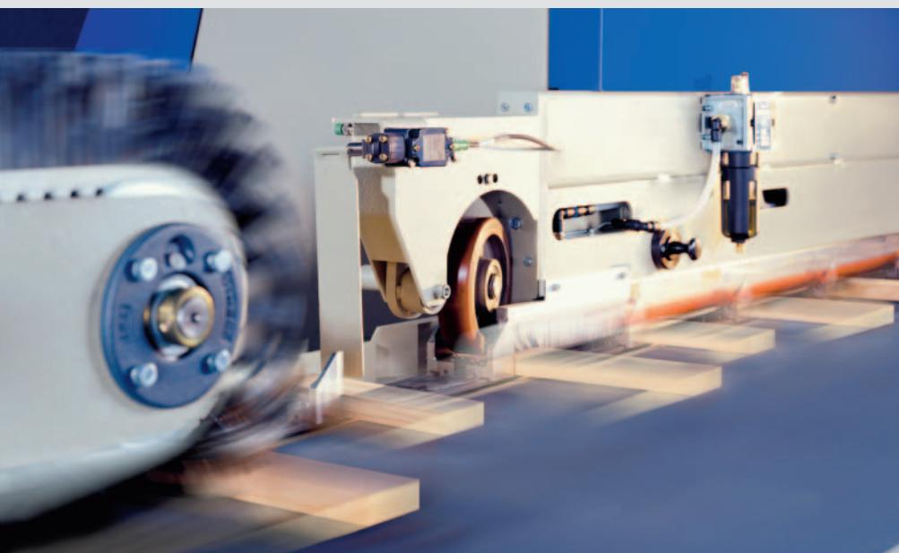
GRECON-ove linije za dužinsko spajanje drveta s ležećim spojem najbrže su linije na cijelom tržištu. Do 180 komada u kontinuiranom prolazu i 12 taktova preše u minuti čine liniju proizvodnim divom. Dodatno se mogu integrirati komponente poput automatskog dodavanja i kontrole obrade prednje strane čime se povećava učinkovitost. Promjer alata je između 228,6 i 266,7 mm (odnosno između 9 i 10,5 inča).
