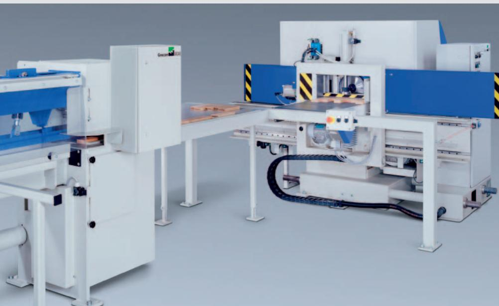
Zahvaljujući modularnom načinu građenje novi osnovni model se može lako nadograditi do kombinacije s dva agregata za obradu. Jednostavno se obrađuju komadi širine do 150 mm, debljine do 55 mm i duljine od 150 mm. Postolje stroja od gusa smanjuje trešnju u području gdje je potrebna preciznost za obradu ozubljenja. Svejedno je, radite li okomite ili ležeće spojeve, ProfiJoint posjeduje jednaku opremu kao i vrhunski modeli GRECON-a.
